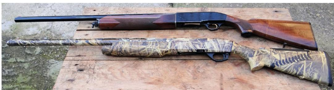
Foto 16 - Sopra, il Beretta A 302 a recupero di gas, sotto il Benelli M2, camouflage, a funzionamento inerziale.
