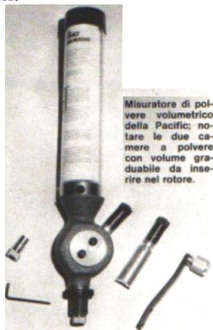
I misuratori a volume o dosatori (Powder Measure) sono presenti in ogni catalogo delle varie produttrici e, più o meno sofisticati e costosi, si basano sul principio di un rotore con camera a polvere che può essere a volume costante oppure graduabile. La polvere, che affluisce dal contenitore per gravità, riempie la camera del rotore che, ruotato, la versa in un imbuto entro cui è imboccato il bossolo.
