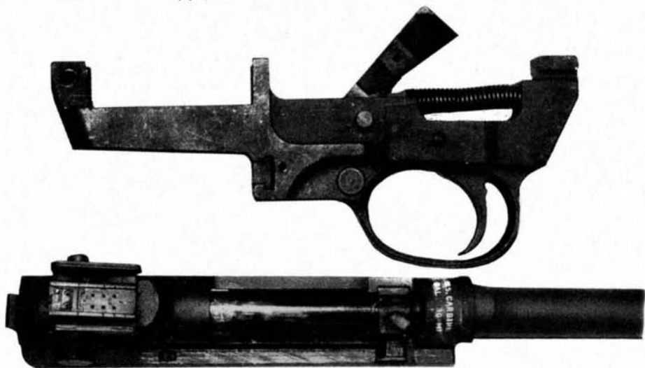
Il congegno di scatto e sicura e un particolare dell'azione dall'alto.
