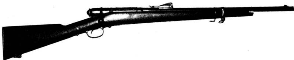
Il moschetto per truppe speciali Modello 1870. Versione successiva con sicura modificata Vitali e alzo graduato da 2 a 12 ettometri.
