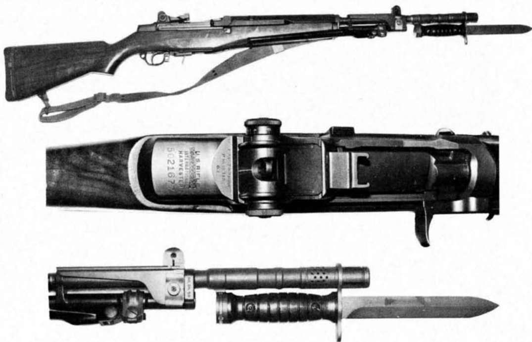
Dall'alto: Il BM 59 ITAL con bretella e baionetta inastata. Particolare del precedente: come si nota è un Garand M1 costruito dalla International Harvester e trasformato dalla Beretta. Particolare del tricompensatore con la baionetta inastata.
