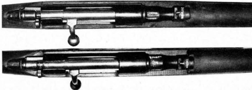
Particolare di due fucili 91/38, uno in calibro 6,5 mm. e l'altro in 7,35, visti dall'alto.
