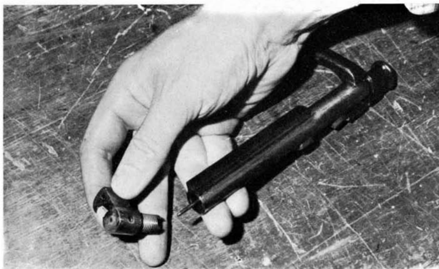
Particolare dell'otturatore con la testa mobile staccata.
