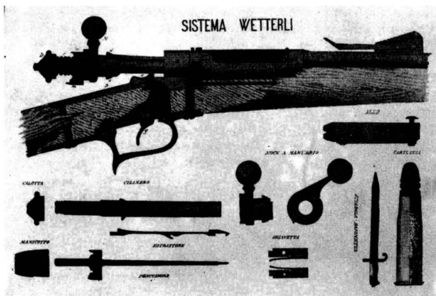
Tavola del fucile Modello 1870 dal Clavarino. L'errata grafia « Wetterli » era piuttosto comune.
