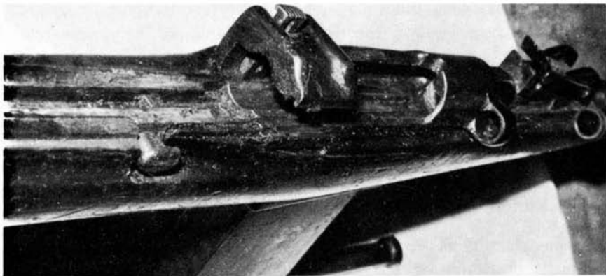
La culatta dell'arma: si noti il gancio di bloccaggio per il manubrio.
