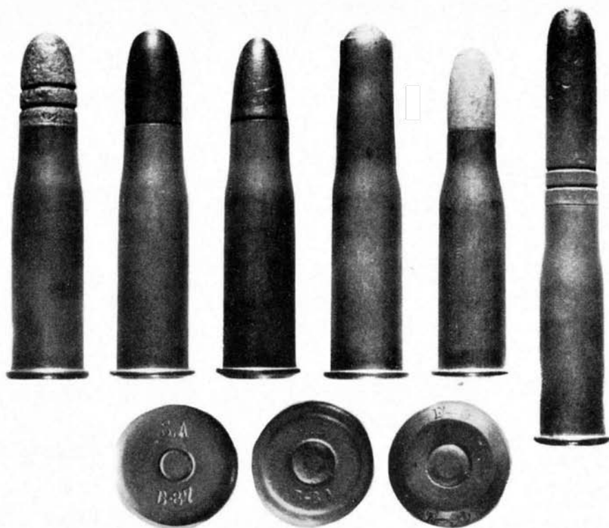
Cartucce e fondelli per armi Vetterli. Da sinistra: Cartuccia per armi Mod. 70 (Vetterli). - Cartuccia Mod. 86 per mitragliatrice (Gardner). - Cartuccia Mod. 90 per armi Mod. 70/87 (Vetterli-Vitali). - Cartuccia a mitraglia. - Cartuccia da salve. - Cartuccia da prova forzata
