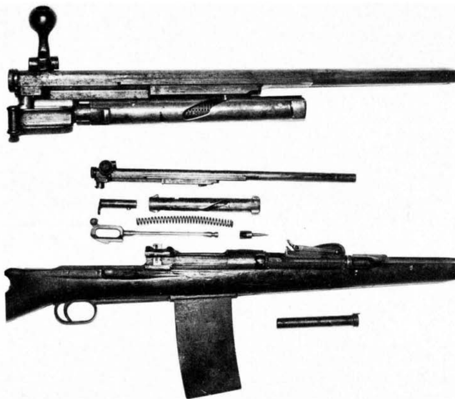
L'otturatore e il pistone (si notino i due punti di collegamento) e l'arma parzialmente smontata.
