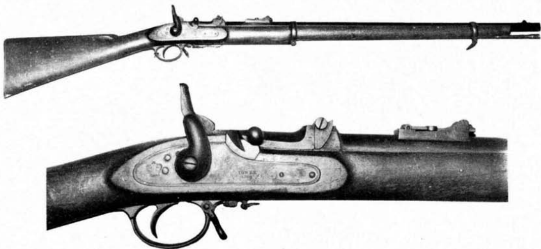
Trasformazione Albini su fucile rigato da sergente P/56 e particolare.
