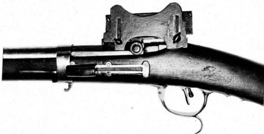
Particolare dell'attacco del cannocchiale. Lo strumento è a sezione rettangolare.
