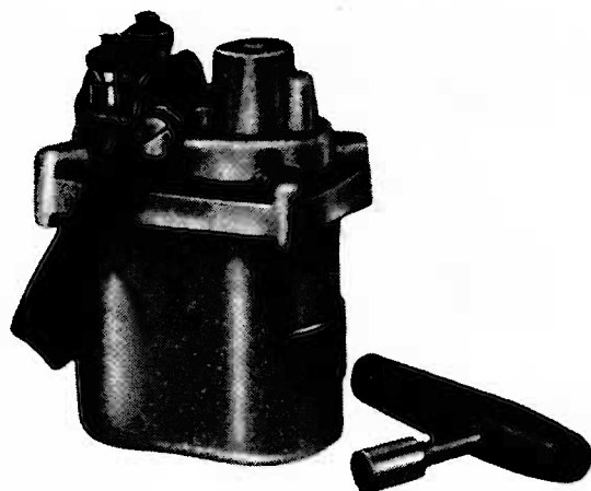
Fig. 11.3 - Esplosore Schaffler tipo 350, con comando diretto a mano, per 50 detonatori in serie con reofori di rame lunghi 2 m
