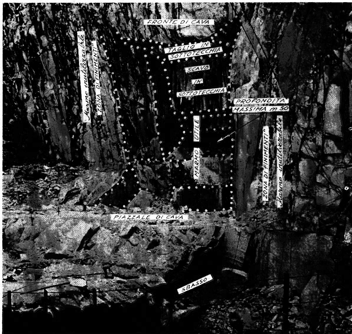
Fig. 13.43 - Varata in sottotecchia, con mine, nella cava « Calagio » a Colonnata di Carrara, della Ditta Adolfo Corsi Succ. (foto I. Bessi, Carrara)
