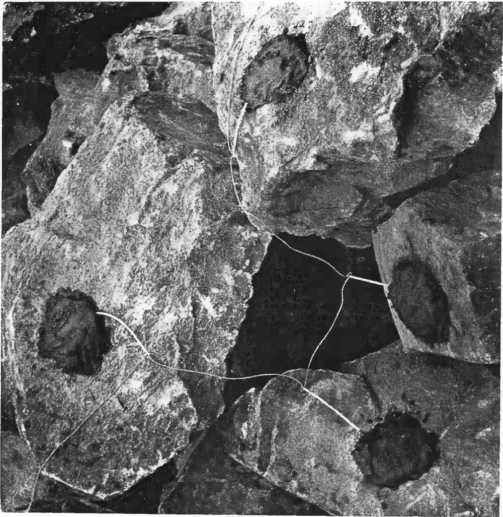
Fig. 17.36 - Petardaggio in volata di blocchi con miccia rapida che collega le singole micce a lenta combustione (Blasting Practice, 3 a ed., 1962, Imp. Chem. Industries)
