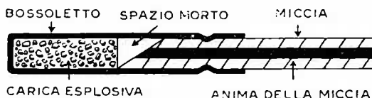
Fig. 8.7 - Miccia tagliata obliqua che lascia uno spazio morto (Coast Manuf. and Supply Co.)
