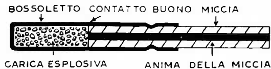
Fig. 8.5 - Miccia tagliata bene e inserita bene nel detonatore (Coast Manuf. and Supply Co.)
