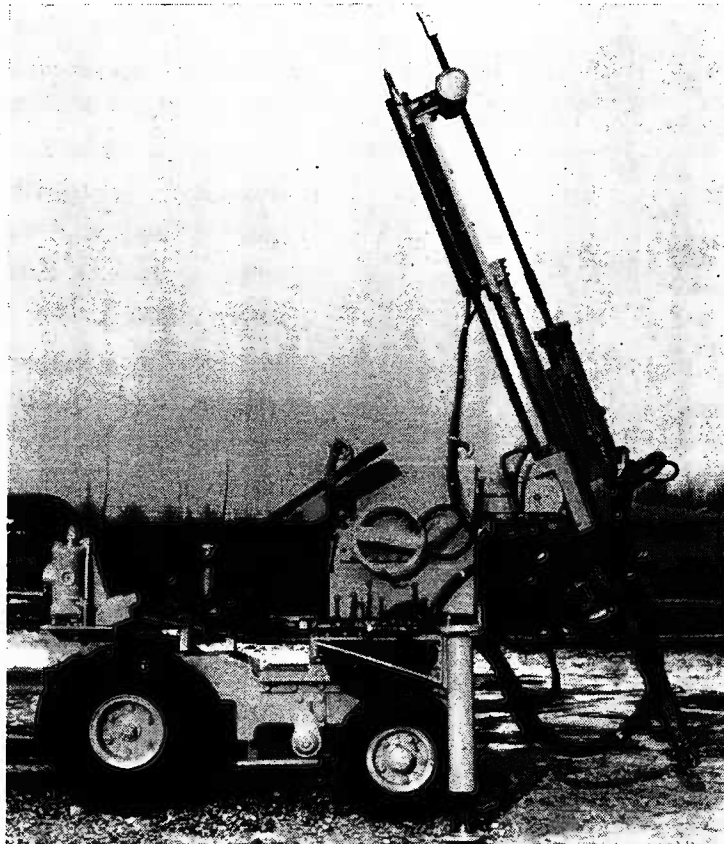
Fig. 5.6 - Wagon drill particolarmente studiato per l'esecuzione di volate con fori a ventaglio, in sottoterraneo (tipo Pavone, della Atlas Copco; servizi fotografici Costa, Milano)
