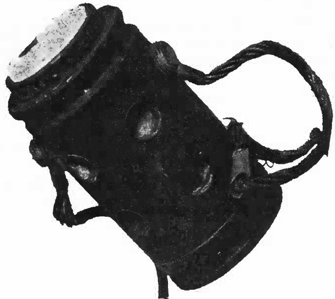
Fig. 17.21 (a destra) - Contenitore con cavi flessibili per il suo recupero: in testa si vede il campione prelevato (Schlumberger)
