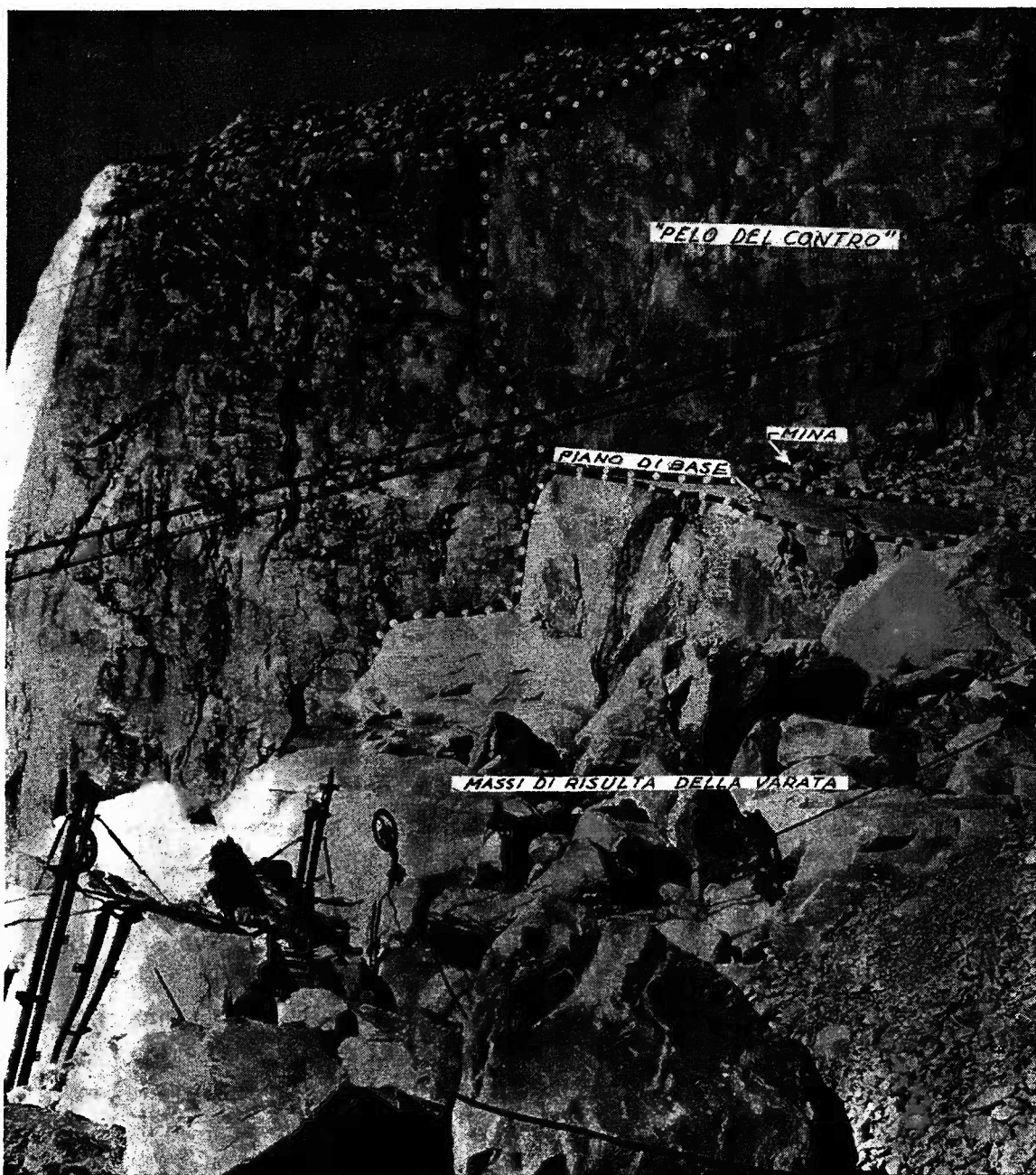
Fig. 13.42 - Varata con taglio di base e piccola mina a camera nella cava di marmo « Campanili » (Carrara), Ditta Adolfo Corsi e Soc. Montecatini (foto I. Bessi, Carrara)
