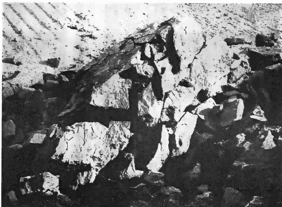
Fig. 17.35 - Un masso rotto in maniera soddisfacente con una carica appoggiata (Nobel Hefte)
