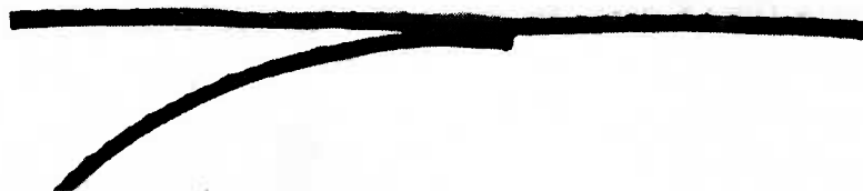
Fig. 8.43 - Derivazione di miccia secondaria nel senso in cui procede la onda esplosiva nella miccia principale, che si suppone da destra verso sinistra (SIPE)
