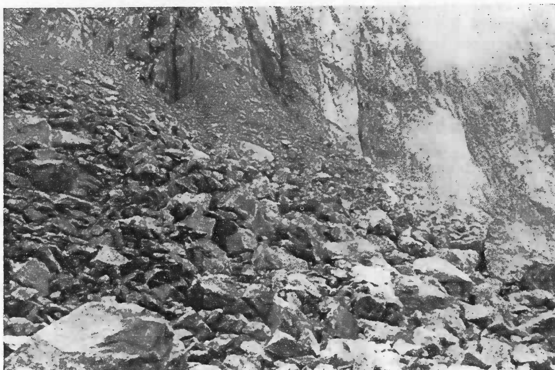
Fig. 14.17 - Effetto di una volata di mine di diametro 90 mm (in alto) e di 150 mm (in basso) a parità delle altre condizioni
