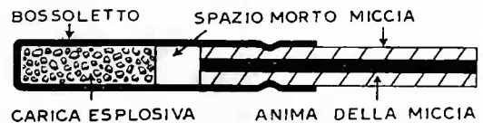
Fig. 8.6 - Miccia introdotta scarsamente nel detonatore lasciando uno spazio morto (Coast Manuf. and Supply Co.)
