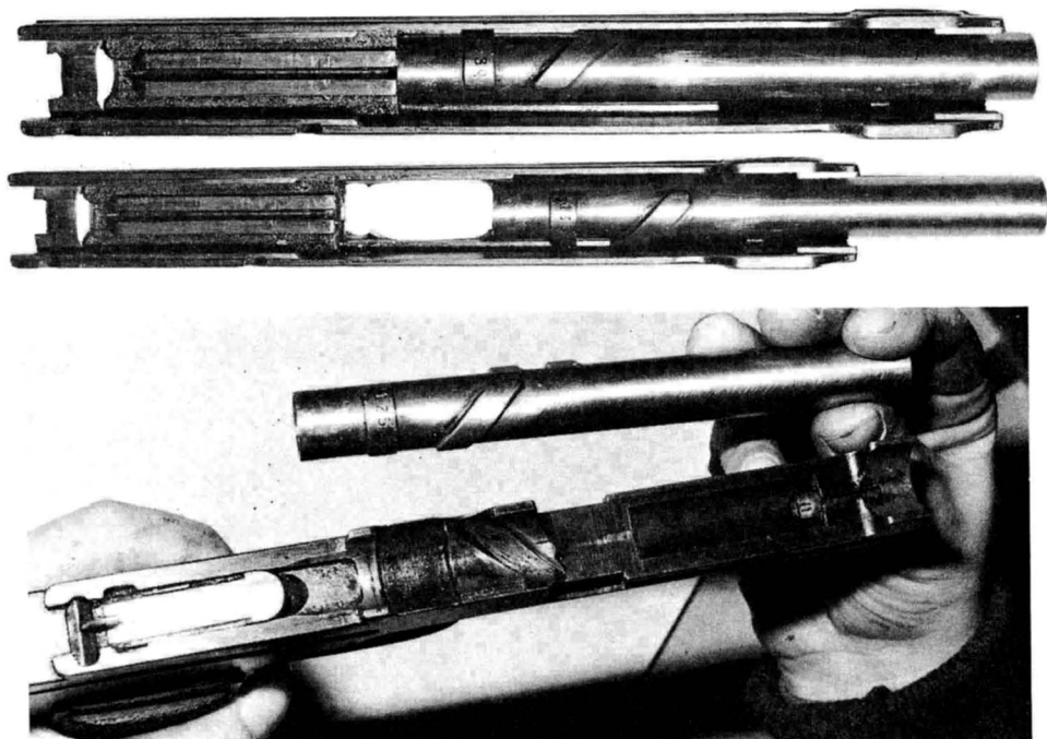
Carrello con canna in chiusura e con canna in apertura. In basso, la canna e la parte superiore del fusto.
