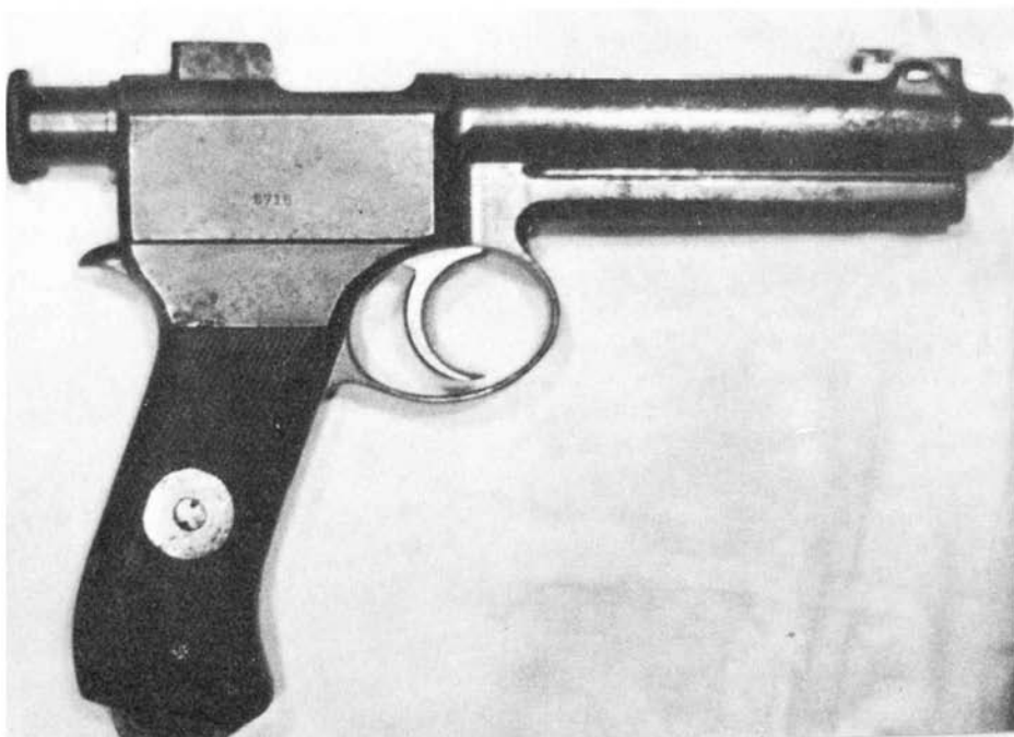
Pistola M 1907 senza disconnettore (1° modello). Si noti la mancanza del perno esterno del disconnettore.
