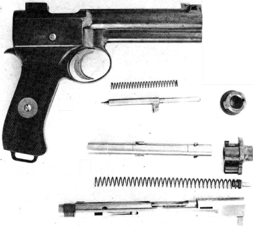
La M 1907 parzialmente smontata. Sotto, particolare con la canna, il tappo di volata e il castello/culatta mobile. Lateralmente a quest'ultimo, sporge la leva della sicura automatica.
