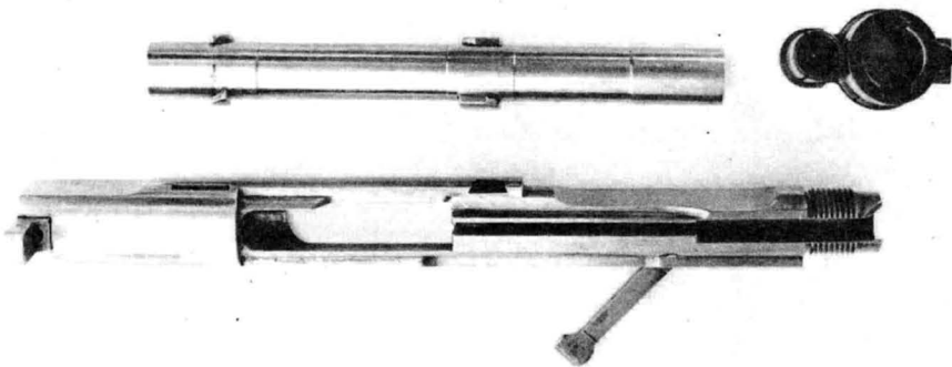
La M 1907 parzialmente smontata. Sotto, particolare con la canna, il tappo di volata e il castello/culatta mobile. Lateralmente a quest'ultimo, sporge la leva della sicura automatica.
