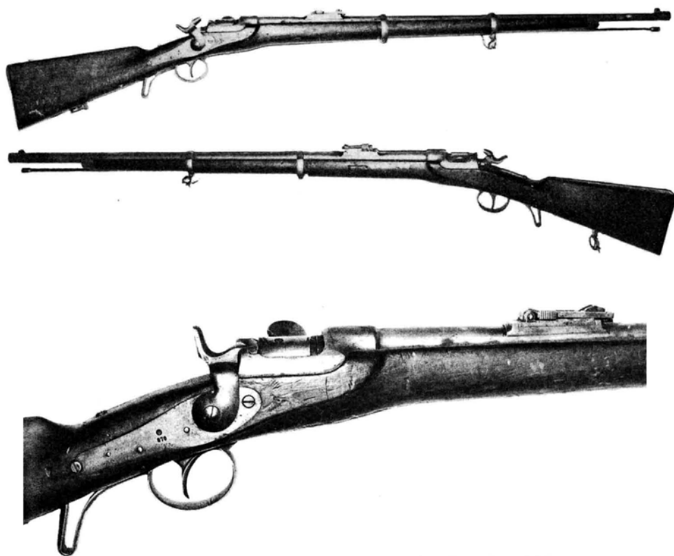
Dall'alto, Infanteriegewehr M 1867 sistema Werndl, lato destro, lato sinistro e particolare del lato destro.
