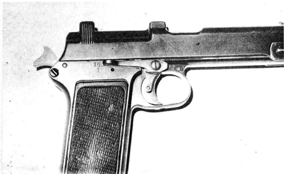
Particolare del lato destro con il selettore. Sotto, particolare dal basso.
