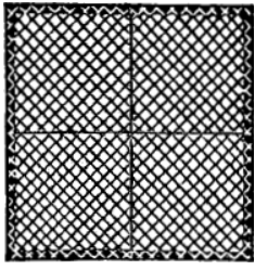
Fig. 6. - Falso terreno di fil di ferro.
